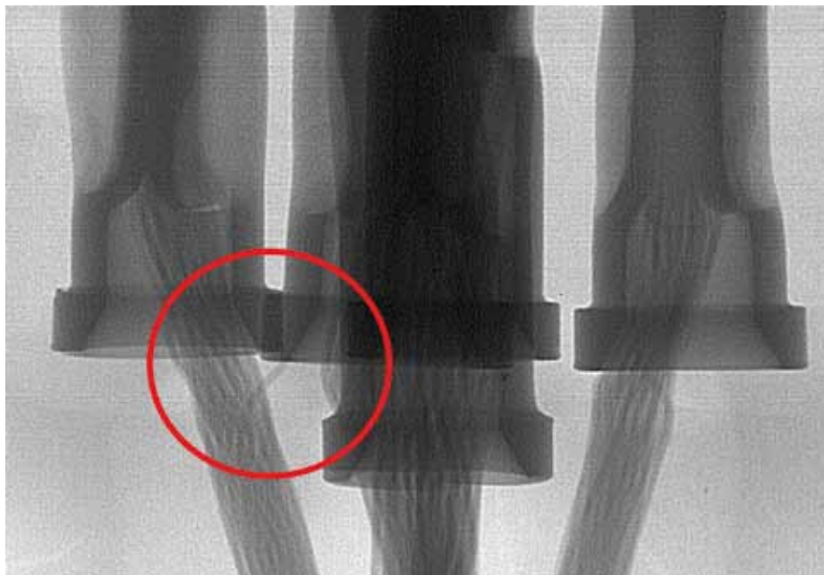
▲ Abb. 4: Ein Crimp-Fehler im vergossenen Teil führte zum Kurzschluss.
